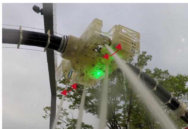
図5 噴射方向可変のノズルモジュール
