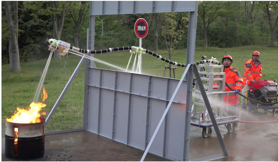
図 2 開発したドラゴンファイヤーファイター初号機
