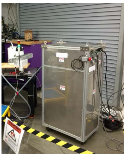
図 2 東北大学金属材料研究所が開発した小型パルス磁場発生用電源。軽量、コンパクトなため、空輸可能で、海外での実験に利用されている。
