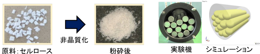
図1 本研究の概要 振動ロッドミルによるセルロースの非晶質化 https://youtu.be/W0YED6mHagY (東北大学多元物質科学研究所 YouTube)
