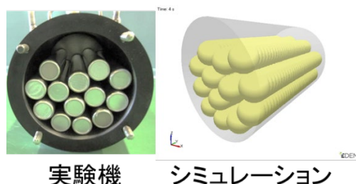
図4 振動ロッドミルの実験とシミュレーション 実験との比較から計算が正しくロッド挙動を再現していることを確認した。
