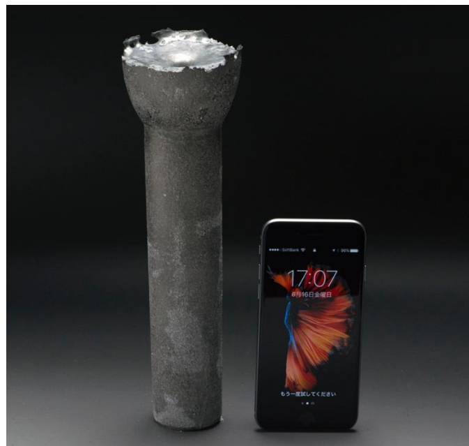
図4 およそ 3.5 kg のモシブチック合金鋳塊の外観写真。
