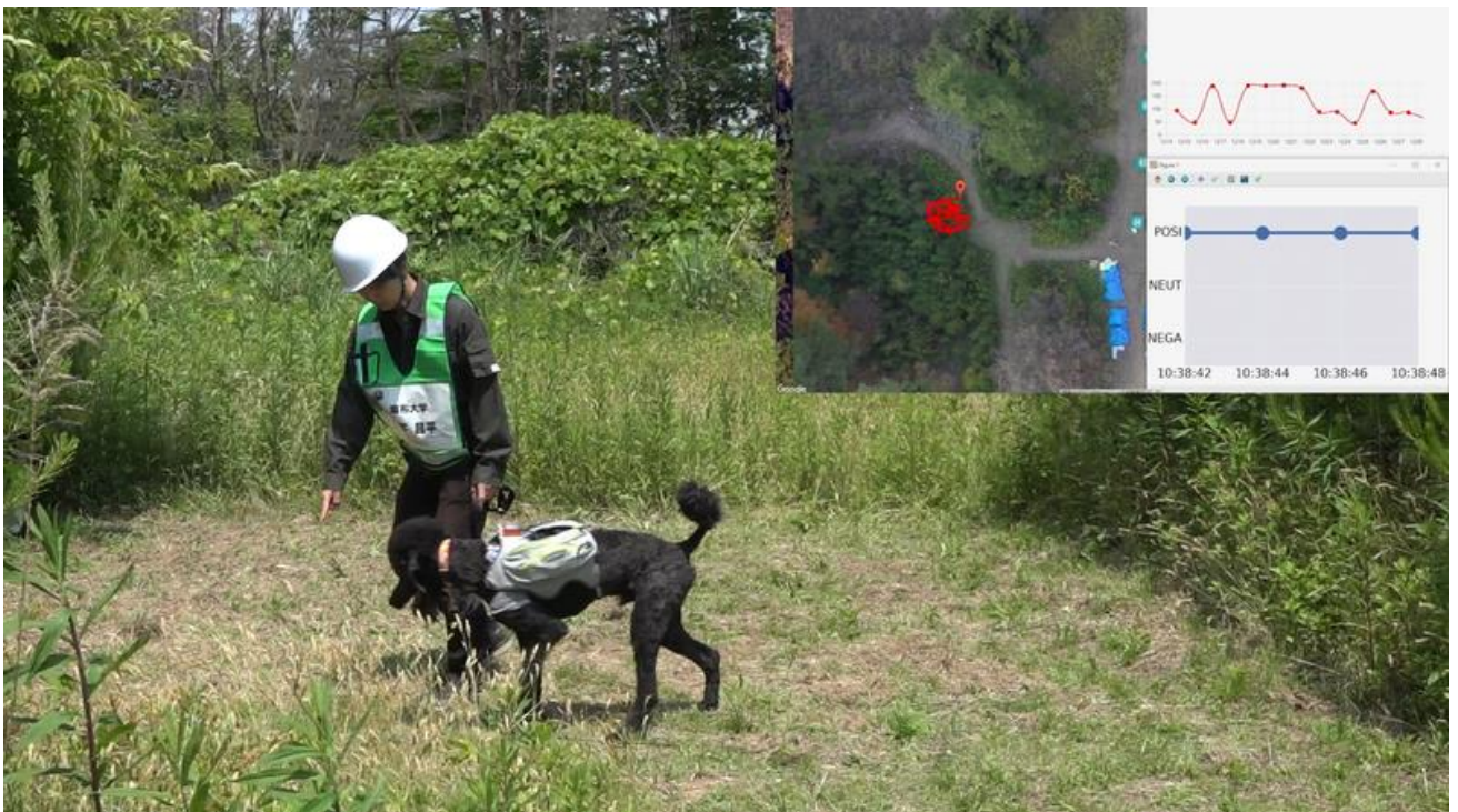
図 7. ImPACT TRC の実証実験で運動中の快情動を予測：右上が探査軌跡と RRI (赤線グラフ) と情動判定 (青線グラフ) の表示結果
