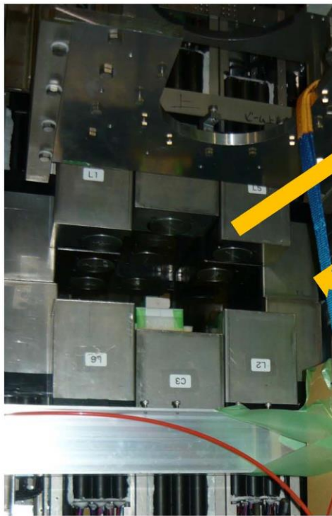
ハイパー核専用のガンマ線測定装置 Hyperball-J
