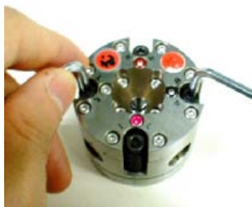
ダイヤモンドアンビルセル高压発生装置の全体図
